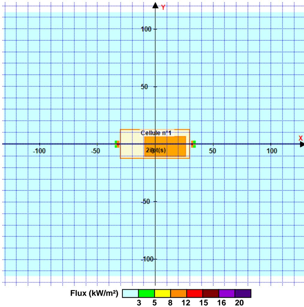
Pour information : Dans l'environnement proche de la flamme, le transfert convectif de chaleur ne peut être négligé. Il est donc préconisé pour de faibles distances d'effets comprises entre 1 et 5 m de retenir une distance d'effets de 5 m et pour celles comprises entre 6 m et 10 m de retenir 10 m.
